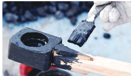
演出前技师要在舀铁水的木板上涂抹隔热涂料。
