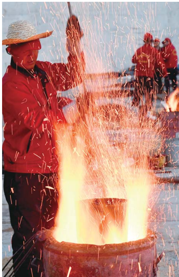
技师需要将温火炉烧热用以保存铁水。
