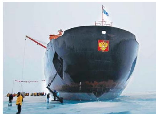
破冰船的坚固的船底呈圆形,可以对坚硬厚实的冰面上形成挤压而不会被严寒冻住。
