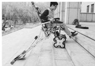
日前,一款由东北大学大三学生设计制作的新一代欠驱动自适应爬楼梯轮椅在东北大学亮相,这款新型轮椅在保障稳定性的同时,还能让轮椅上的残障人士正向“迈步”走楼梯。
