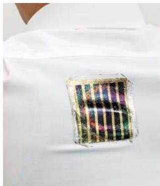
日本研究团队近日开发出了一种具有伸缩性、可水洗的超薄型太阳能电池,这种电池可以贴在衣服上,并可用作穿戴设备的电源。
