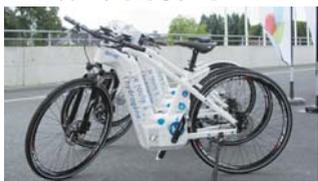
法国初创企业普拉格马工业公司已开始量产氢动力自行车。普拉格马的“阿尔法”氢动力自行车携带两升氢气瓶,最远里程约100公里,但重新充气时间只需数分钟。1公斤氢气蓄能比同等重量的锂电池多600倍。不过,报道并未写明自行车的最高时速。
